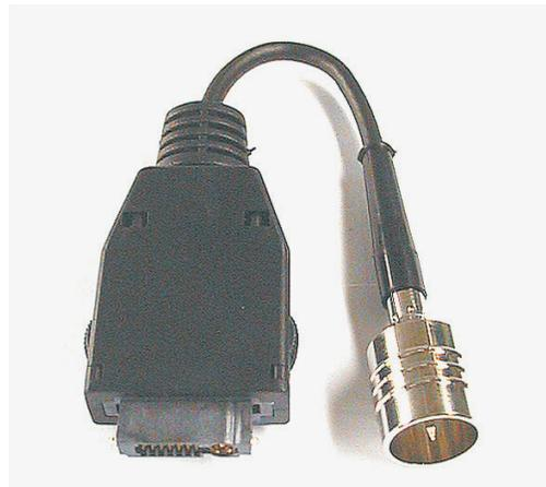
Wegen der Vielzahl unterschiedlicher Mobiltelefone sind für kabelgebundene Tests HF-Adapter erforderlich. Diese verbinden den HF-Anschluss der Mobiltelefone mit dem HF-Adapterkabel, das zum Tester führt. Willtek empfiehlt diese Form der Ankopplung, wenn Sie Präzisionsmessungen durchführen möchten.
