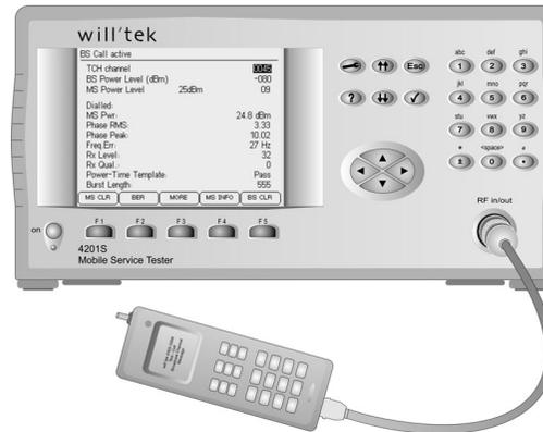
*Kabelgebundene Ankopplung des Prüflings ist für Präzisionsmessungen die beste Wahl.*
