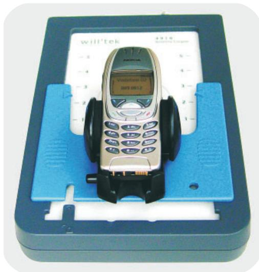
Beim 4916 Antenna Coupler kommt es darauf an, Mobiltelefone eines Typs immer in derselben Position zwischen den Halteklammern zu platzieren.
