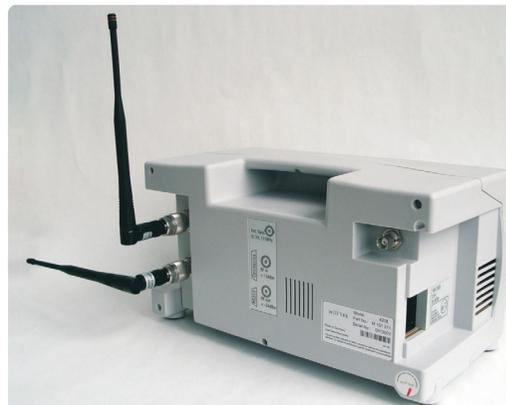
*Empfehlung: Die um 90° gedrehte Ausrichtung der Antennen kommt der Entkopplung zwischen dem RX- und TX-Signalweg zugute.*
